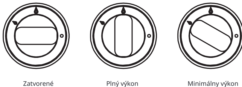
Obr. 1 Poloha ovládača ventilu plynových horákov
